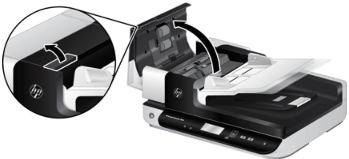
3. Deslice el dedo por detrás de la lengüeta de la puerta del conjunto de rodillos y tire suavemente hacia adelante y hacia abajo para abrir la puerta.
