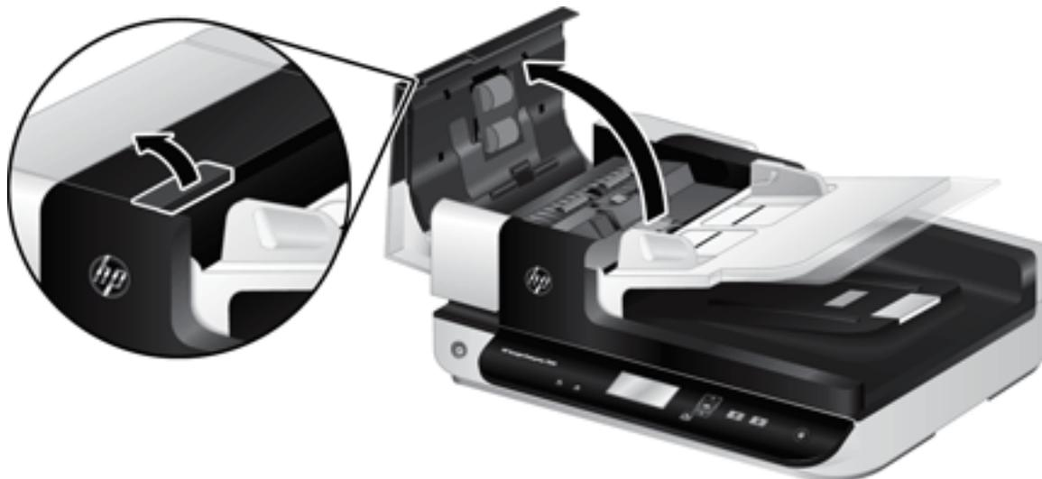
3. Retire toda la pelusa o suciedad que vea de cada uno de los rodillos de alimentación y el panel de separación usando aire comprimido o un paño limpio sin pelusa humedecido con agua caliente.
