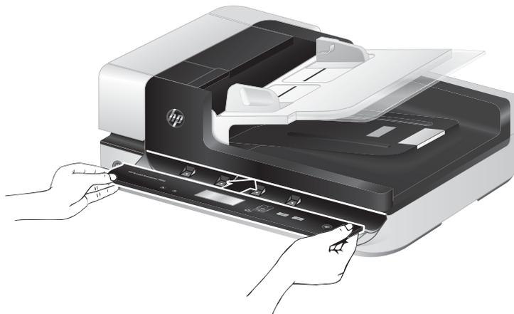
8. Empuje suavemente el panel frontal contra el bisel (asegurándose de que el panel frontal se ha alineado correctamente), gire hacia abajo y presione el panel frontal hasta que coloque correctamente.
