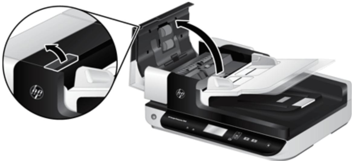
3. Pulse hacia adelante (hacia la parte posterior del AAD) en el seguro del panel de separación para soltar el panel de separación.
